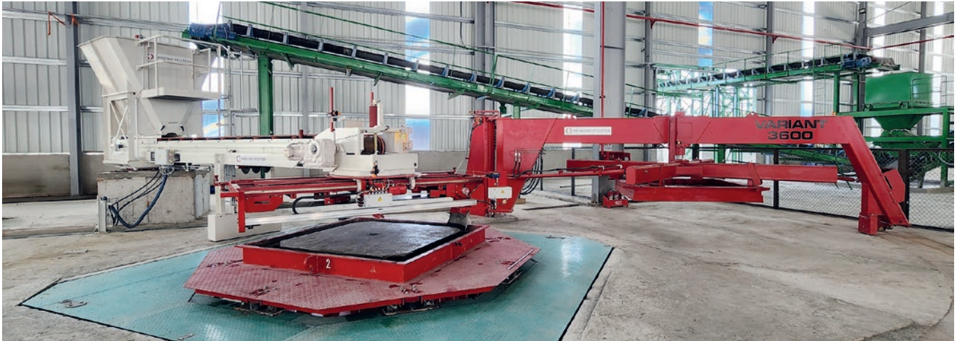
Variant 3600E (D) for large concrete pipes and box culverts production
