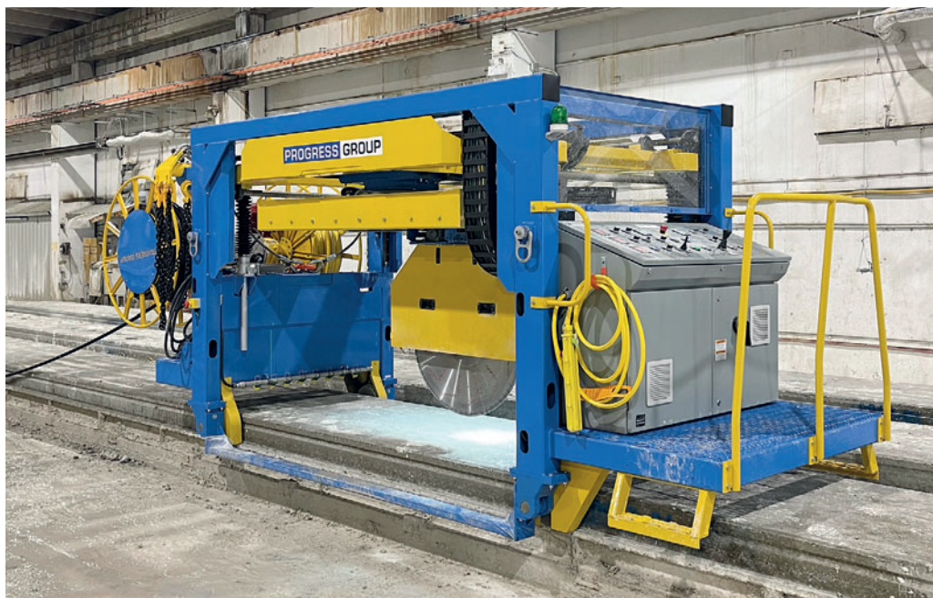
Пила Angle Pro S выполняет разрезы в бетоне под любым углом
