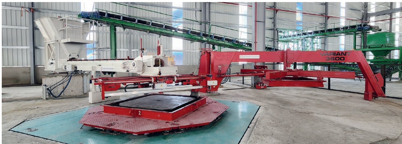
Maszyna VARIANT 3600E (D) do produkcji wielkogabarytowych rur betonowych i przepustów skrzynekowych.
