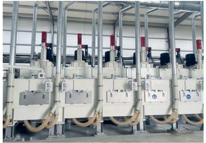
Maszyna szlifująca SR Star 8126.
