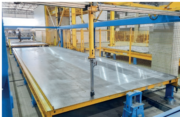
Ploter precyzyjnie nanosi kontury przyszłego elementu betonowego na podkład.
