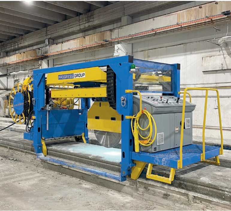
Piła Angle Pro wykonuje cięcia w betonie pod dowolnym kątem.
