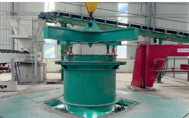
Operazione di sollevamento di un VARIANT con carro ponte
