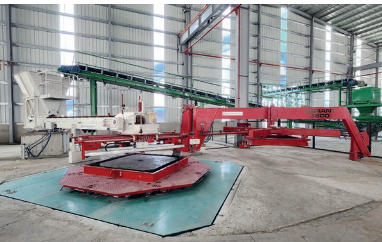
Variant 3600E (D) para la producción de grandes tubos de hormigón y marcos
