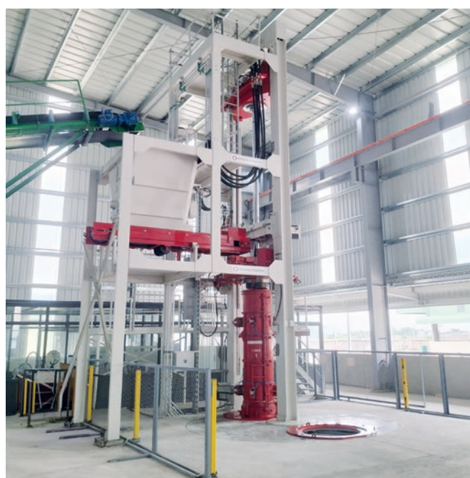
Vista lateral de la prensa radial RP 1230-4
