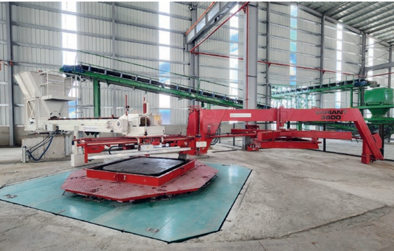
Variant 3600E (D) für die Fertigung großer Betonrohre und Rahmendurchlässe
