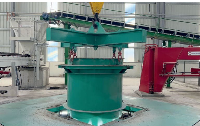
Hebevorgang eines VARIANT mit Laufkran
