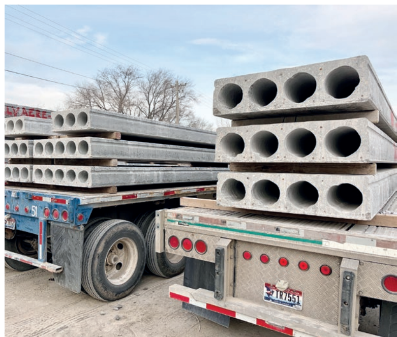
Spannbetonfertigdecken vor dem Abtransport zum Kunden
