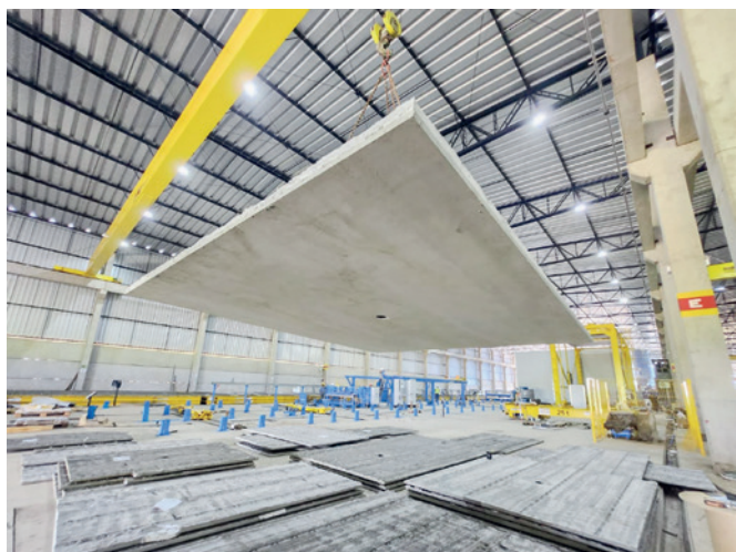
预制构件采用软件控制系统进行生产和运输，其中部分流程已实现全自动化这节省了时间和成本，并使生产更加安全
