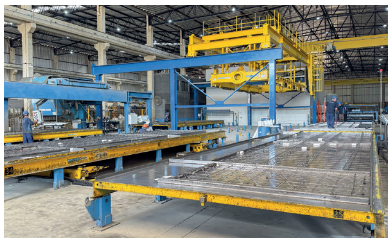
自现代化改造以来，带现浇叠合层的预制楼板及双面叠合墙的生产一直在全面进行中
