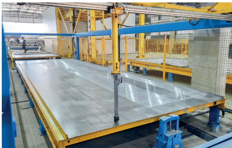
绘图仪在模台上精确标出未来混凝土构件的轮廓
