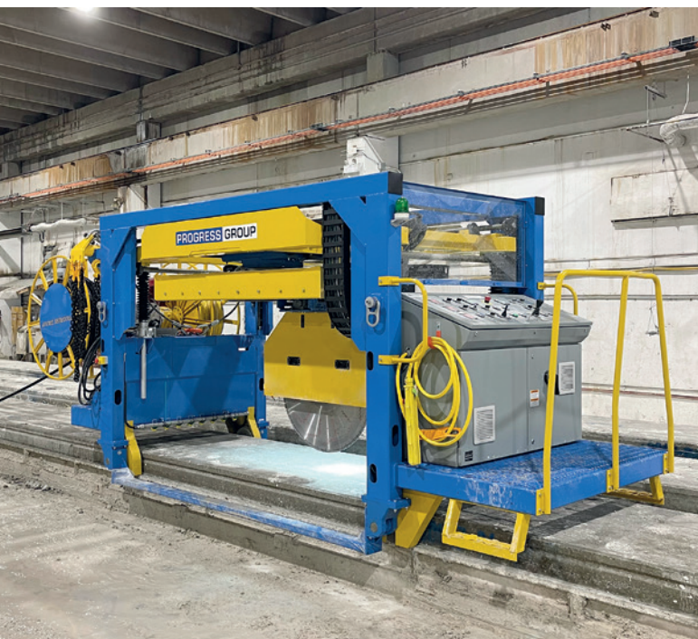
Angle Pro 锯可以任意角度切割混凝土
