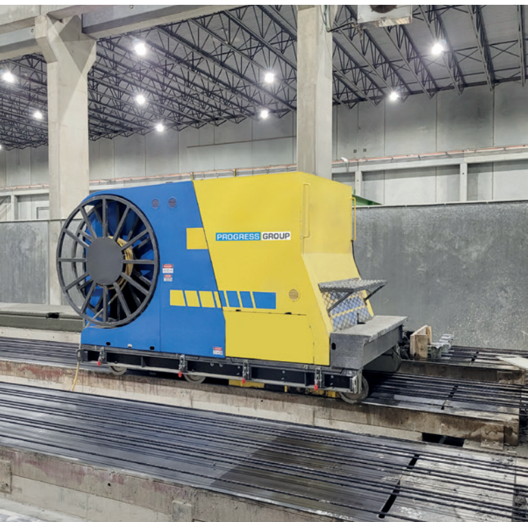
新型挤出机可确保最低的材料消耗，并加快预应力空心楼板的固化速度
