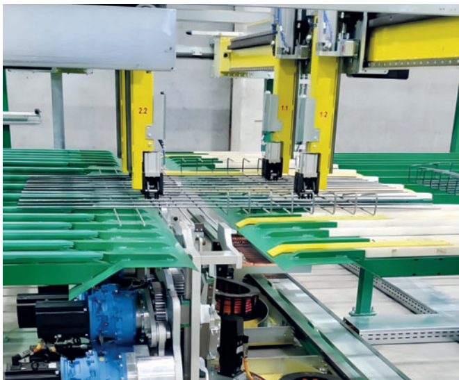
Система захватов для перемещения плоских и изогнутых арматурных сеток
