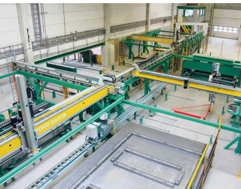
Робот Form Master для установки, снятия и хранения опалубки точно размещает опалубку на поддоне
