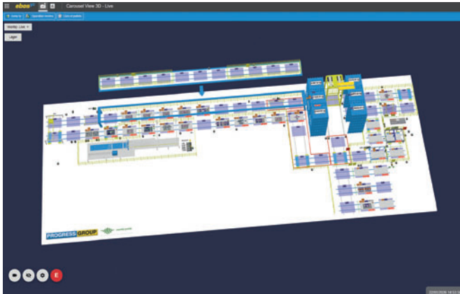
Графический анализатор производительности в Ebos® с 3D-визуализацией карусельной установки
