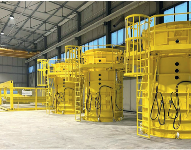
Установка для обработки футеровки и трубные литейные формы от Schlüsselbauer Technology перед окончательным вводом в эксплуатацию
