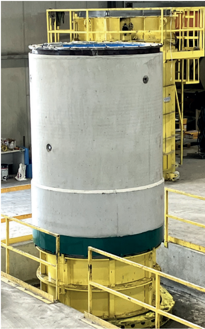
Только что распалубленная промежуточная домкратная труба с частично уменьшенной толщиной стенки
