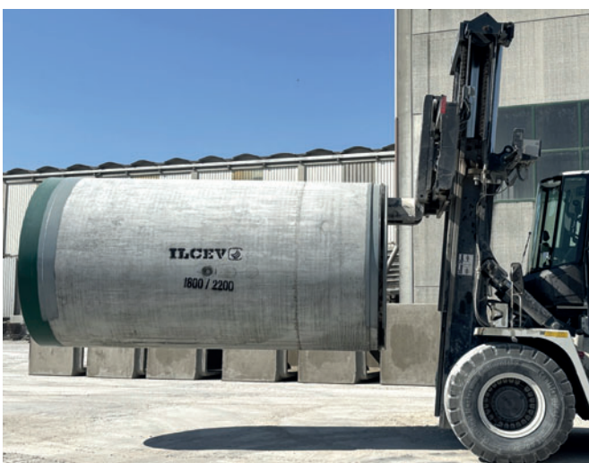
Бережная погрузка труб с ПЭ-облицовкой с помощью обрезиненных вилок погрузчика. ILCEV специализируется на производстве трубопроводов, укладываемых методом микротоннелирования. С 2024 года компания входит в состав Gruppo Grigolin, международной группы строительно-инженерных компаний
