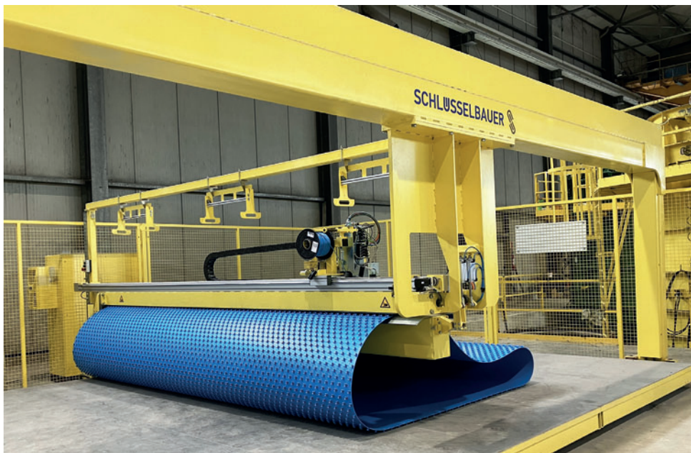
Установка для автоматической сварки защитных плит Agru Ultra-Grip для бетона в цилиндры – ключевой элемент в производственной цепочке на предприятии ILCEV
