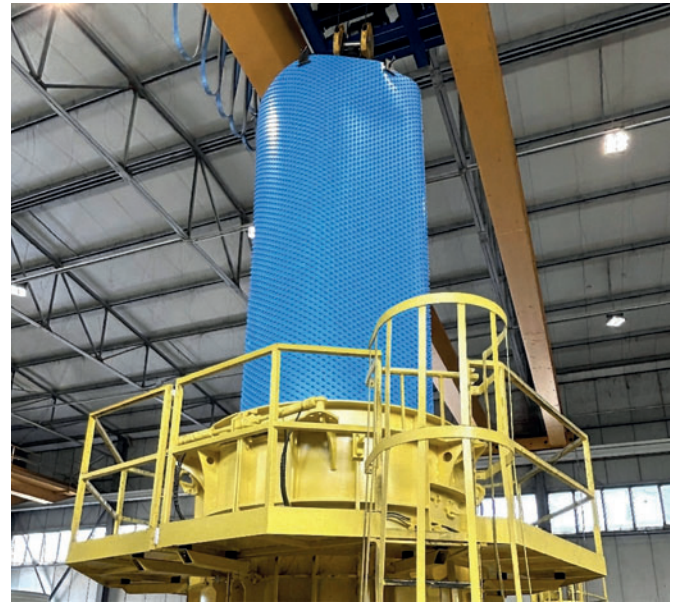
Установка цилиндрической футеровки, изготовленной из защитных плит Agru для бетона, в 4-метровые трубные литейные формы
