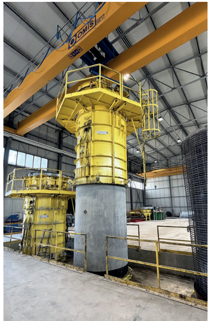
Распалубка наружной формы – еще одна труба готова к выгрузке
