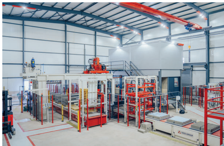
Разъединитель блоков точно сдвигает блоки вместе
