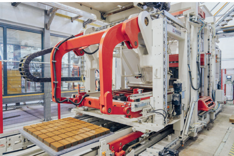
Центральным технологическим компонентом бетоноформовочной линии является вибропресс RH 1500 4 MVA
