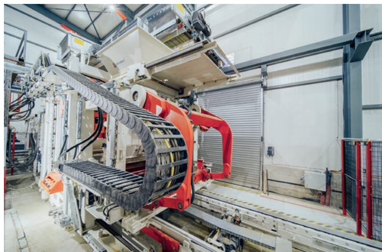
Wibroprasa RH 1500-4 MVA stanowi technologiczne serce linii do produkcji wyrobów betonowych.
