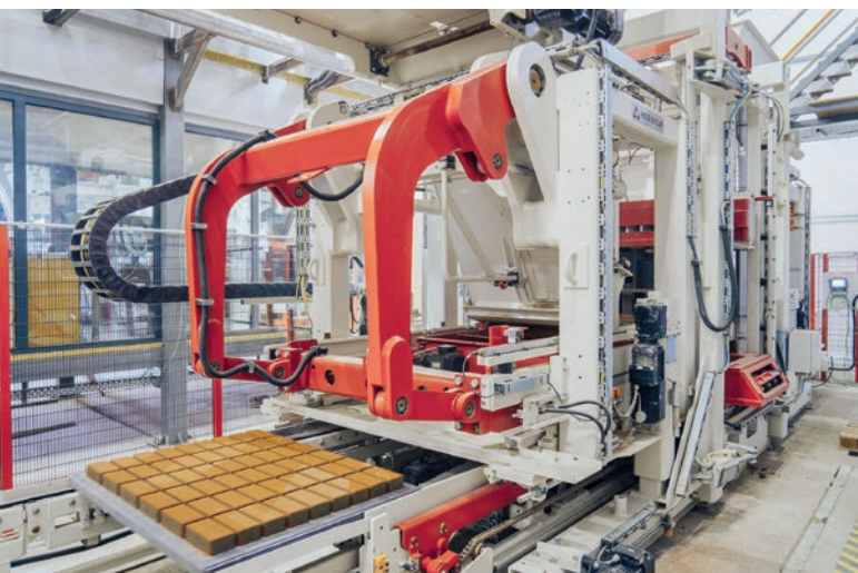
Wibroprasa RH 1500-4 MVA stanowi technologiczne serce linii do produkcji wyrobów betonowych.
