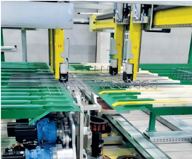
Trawersa z chwytakiem oraz system gięcia – do transportu i obróbki płaskich oraz giętych siatek zbrojeniowych.
