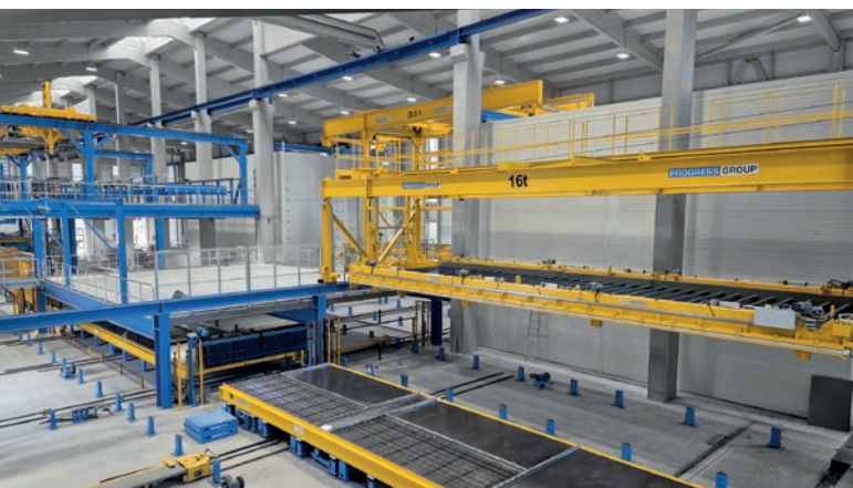
Il dispositivo voltapezzi automatico viene impiegato nella produzione di pareti doppie.
