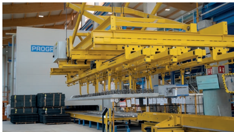
Con la traversa di sollevamento si provvede a prelevare l'elemento dal pallet e a prepararlo all'ulteriore trasporto.
