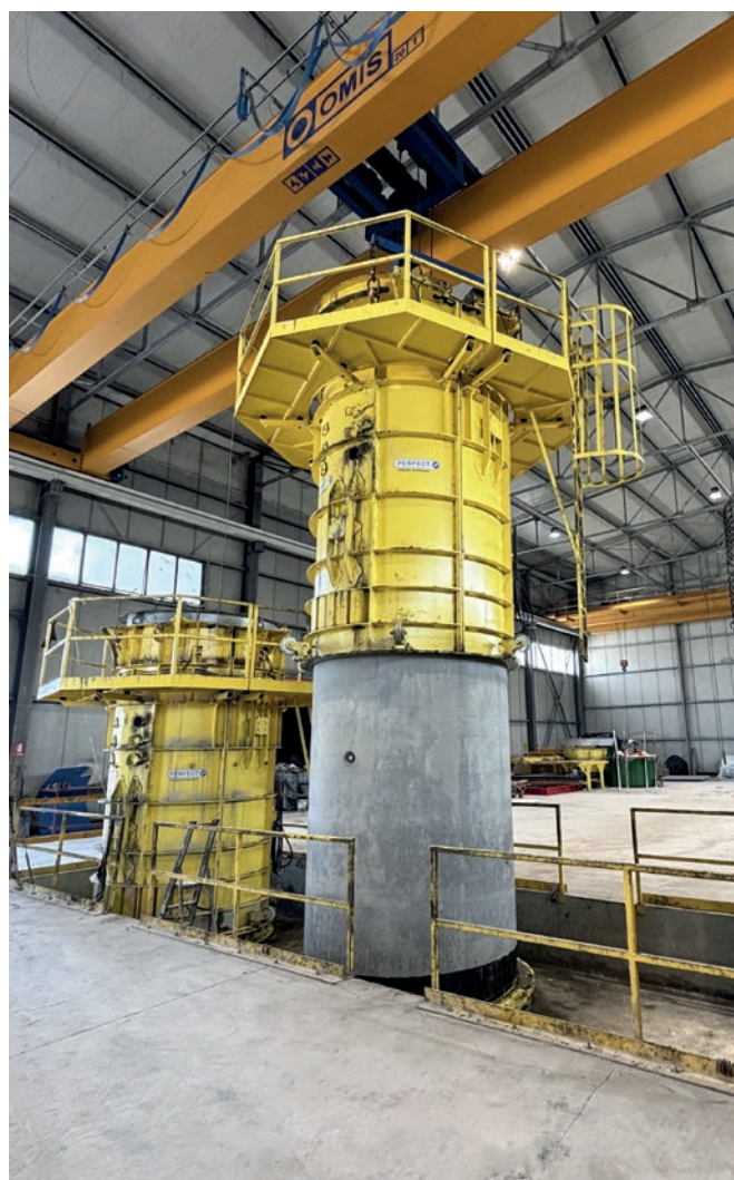
Disarmo dello stampo esterno: un altro tubo è pronto per essere prelevato
