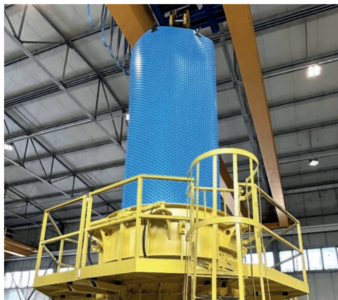
Inserimento del cilindro di rivestimento, costituito da pannelli protettivi per calcestruzzo AGRU, negli stampi per tubi di 4 m di altezza
