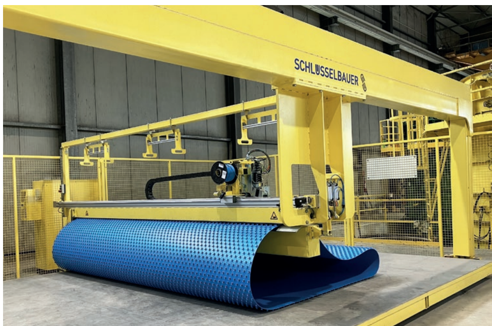
L'impianto di saldatura automatica per la formazione di cilindri a partire da pannelli protettivi in PE per calcestruzzo Ultra-Grip: un elemento fondamentale nella catena di produzione di ILCEV
