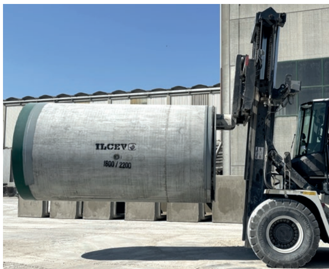
Il carico di tubi rivestiti in PE avviene attentamente tramite denti di carrelli elevatori rivestiti - ILCEV è specializzata nella produzione di condutture per la posa a spinta di tubi. Dal 2024 fa inoltre parte del GRUPPO GRIGOLIN, un gruppo aziendale attivo a livello internazionale, specializzato nel settore edile e delle costruzioni.
