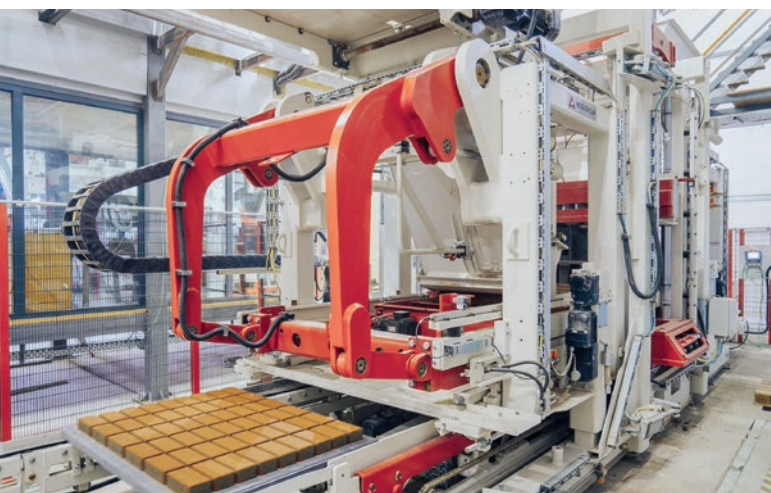
La blocciera RH 1500-4 MVA costituisce il cuore tecnologico della produzione di blocchi
