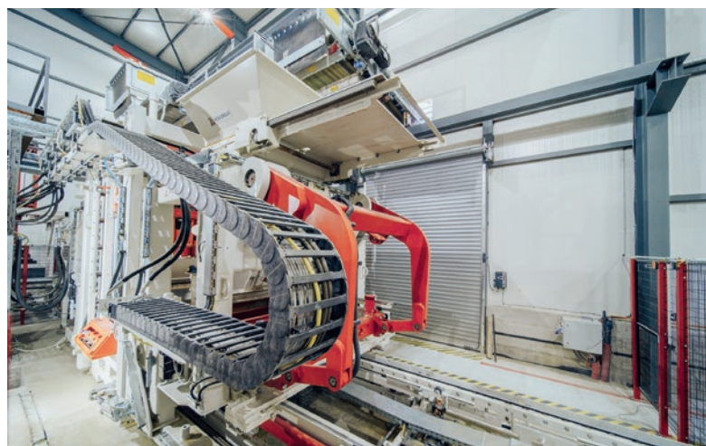
La blocciera RH 1500-4 MVA costituisce il cuore tecnologico della produzione di blocchi
