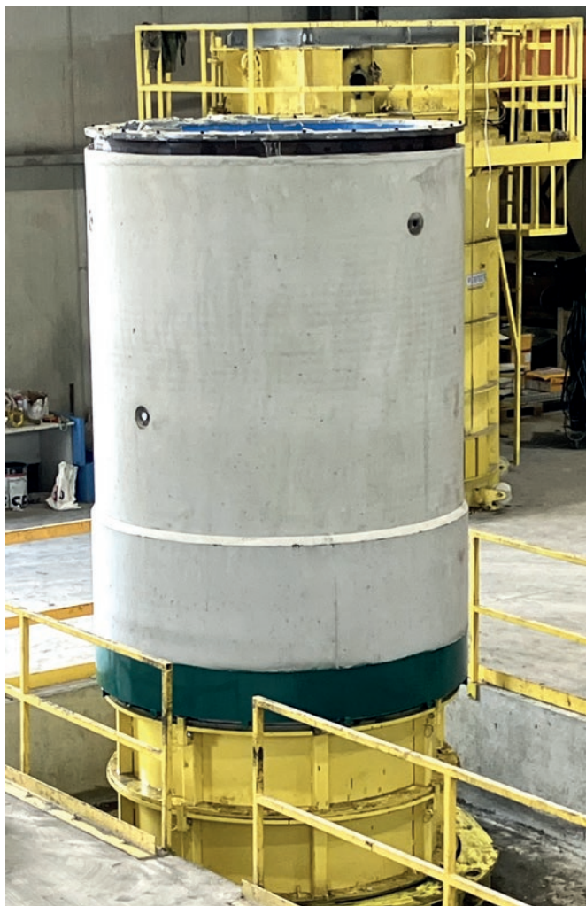
Station intermédiaire avec épaisseur de paroi partiellement réduite fraîchement démoulée
