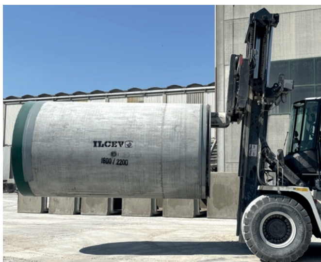
Chargement en douceur de tuyau revêtus de PE avec des fourches de chariot-élévateur gainées - L'entreprise ILCEV est spécialisée dans la fabrication de conduites pour les activités de fonçage. Depuis 2024, elle fait partie du groupe international GRUPPO GRIGOLIN, spécialisé dans la construction et le génie civil.
