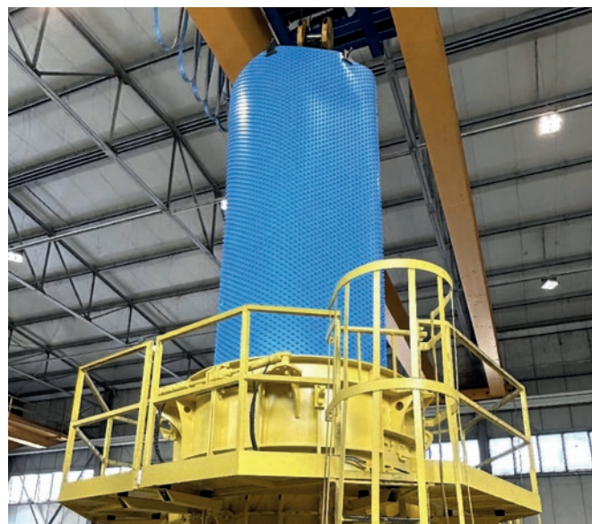
Insertion du cylindre de revêtement fabriqué à partir de plaques de protection du béton Agru dans les moules de tuyaux de 4 m de haut
