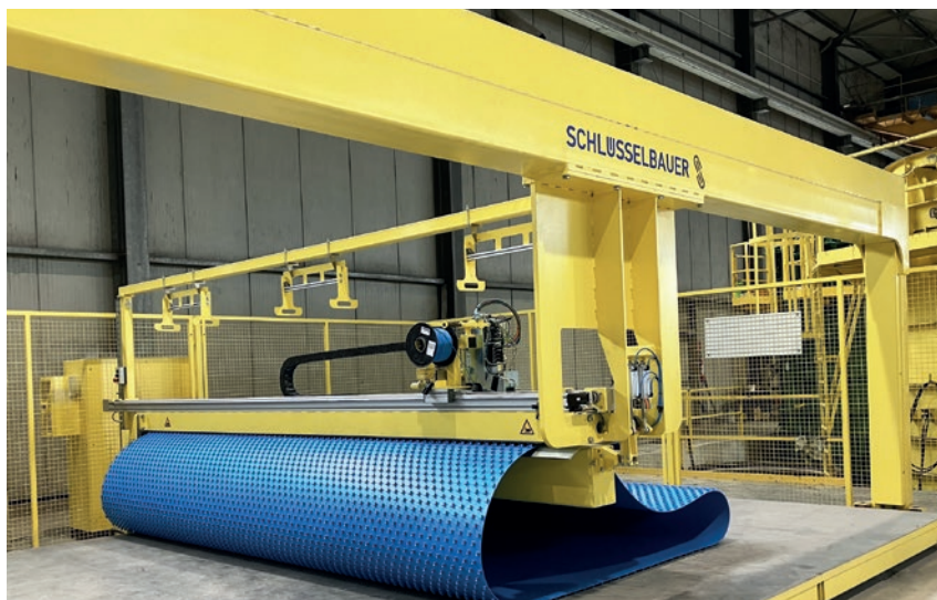
L’installation de soudure automatique des plaques de protection du béton en PE Ultra-Grip pour la formation de cylindres – un élément central de la chaîne de production chez ILCEV
