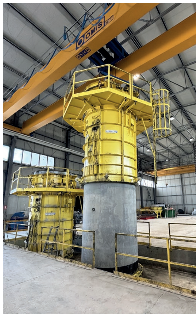
Démoulage de l'enveloppe extérieure - un autre tuyau est prêt à être sorti
