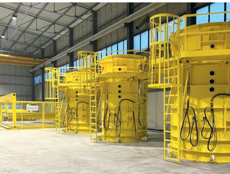
Installation de finition du revêtement et des moules de tuyaux de Schlüsselbauer Technology avant la mise en service finale
