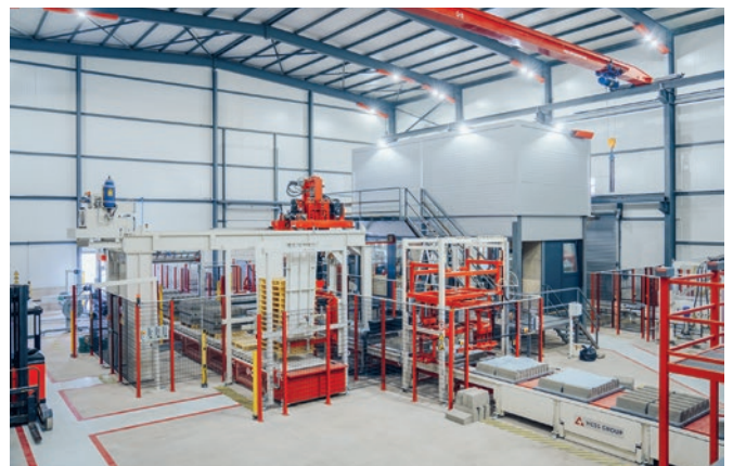
Le séparateur de blocs rassemble les produits avec précision.
