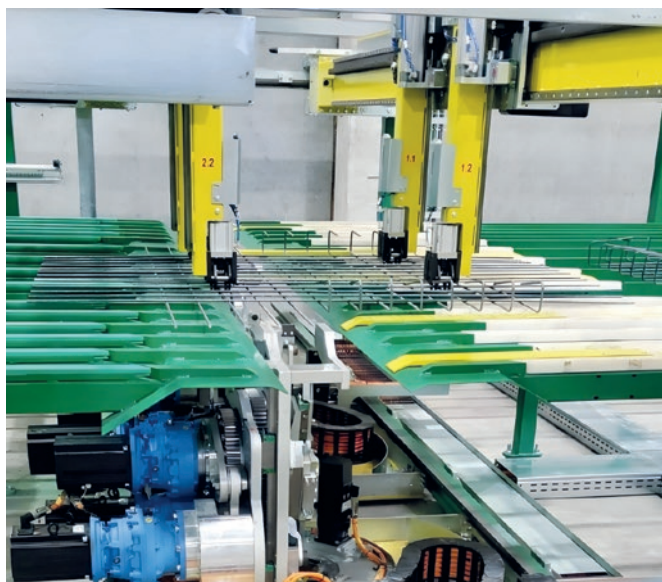
Système de préhension, de transport et de pliage pour treillis d'armature plats et pliés.
