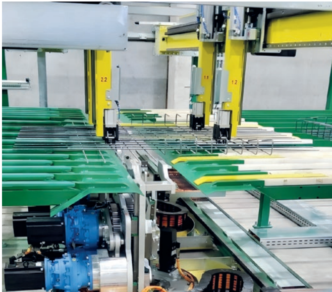
Greifertraverse und Biegesystem für flache und gebogene Bewehrungsmatten
