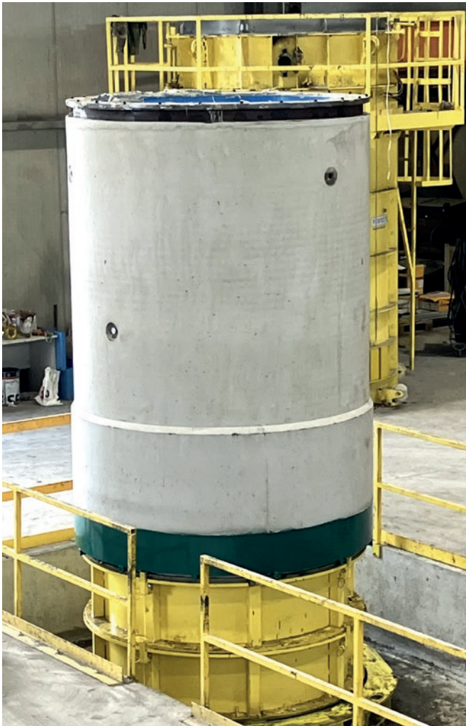
Soeben entschaltes Zwischenpress-Rohr mit partiell reduzierter Wandstärke
