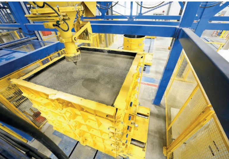
Perfect Forming Technology - hier Rechteck-Formen - ausgelegt für die Verarbeitung von SVB, alle Dicht- und Fahrelemente werden bei Schlüsselbauer Technology hochpräzise maschinell bearbeitet
