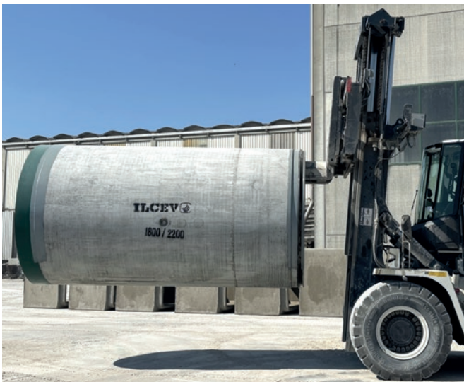
Schonende Verladung PE-ausgekleideter Rohre mit ummantelten Staplerzinken - ILCEV ist auf die Herstellung von Rohrleitungen für den Rohrvortrieb spezialisiert. Seit 2024 sind sie zudem Teil der Gruppo Grigolin, einer international tätigen Unternehmensgruppe, mit Schwerpunkt auf Bau- und Konstruktionswesen.
