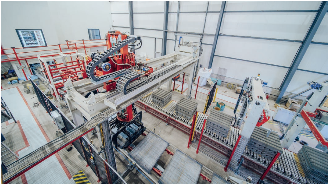
Der Paketierer nimmt die Steinlagen auf, richtet sie aus und legt sie auf dem Auslaufband ab.
