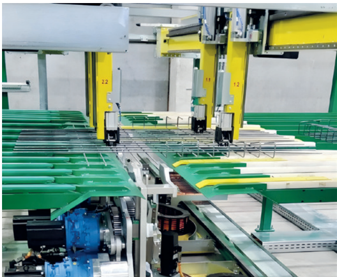
适用于平面和弯折钢筋网片的抓取器横移及弯曲系统
