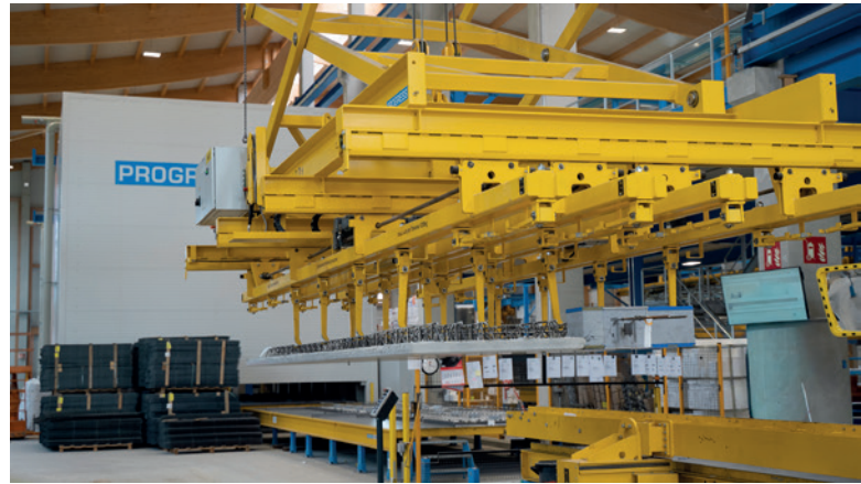
起重横梁将成品构件从台车上取下，并为其继续运输做好准备
