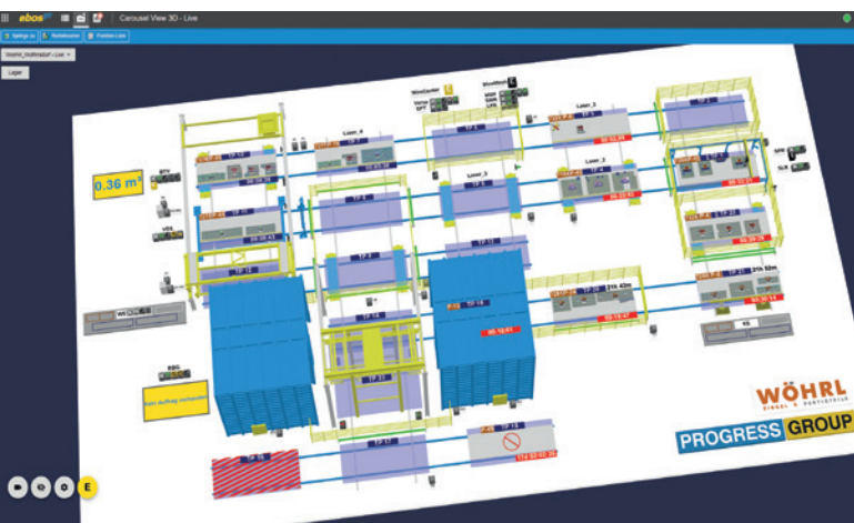
ebosyc控制着转盘式工厂，并通过3D可视化实现实时监控和后续分析。此外，智能生产屏幕在生产过程中的最佳节点提供必要的信息
