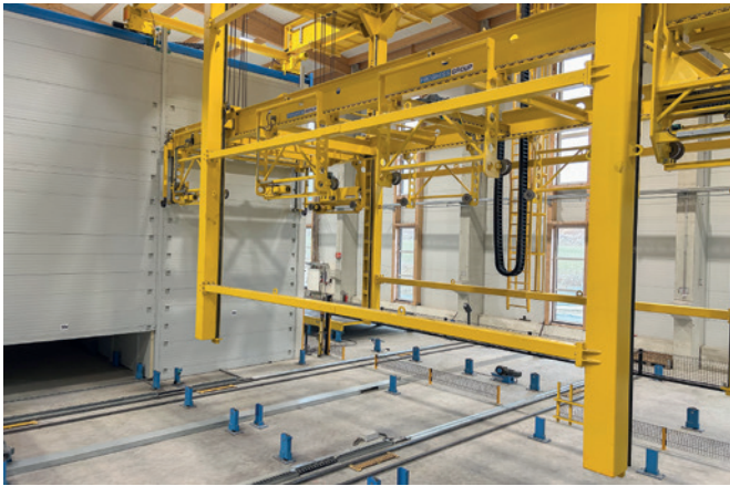
养护构件最有效的方法是在干燥室中。一台堆垛起重机负责台车的全自动装载和卸载
