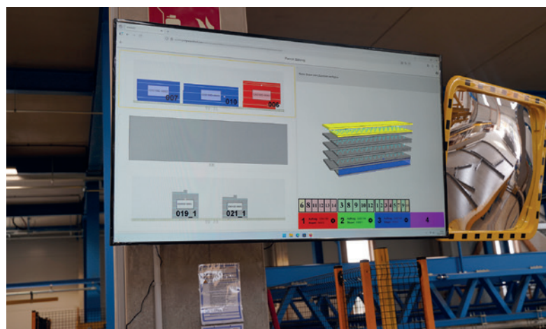
ebosyc控制着转盘式工厂，并通过3D可视化实现实时监控和后续分析。此外，智能生产屏幕在生产过程中的最佳节点提供必要的信息
