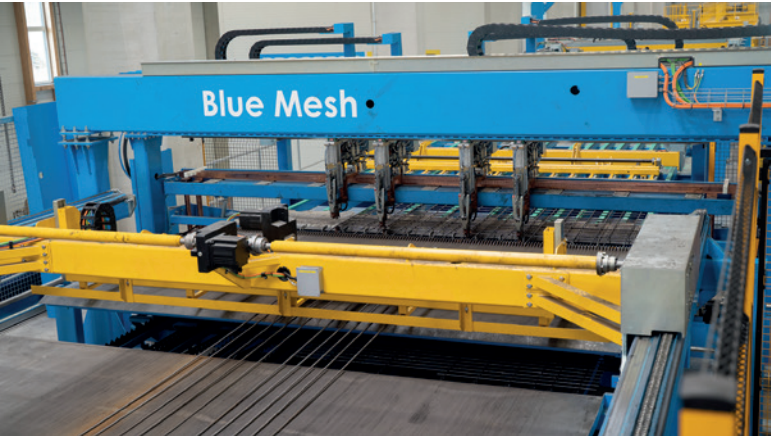
新的M-System BlueMesh焊网机能够全自动地从上部和下部将横筋焊接到纵筋上
