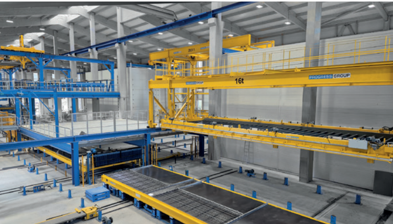
自动翻转装置用于双层墙的生产
