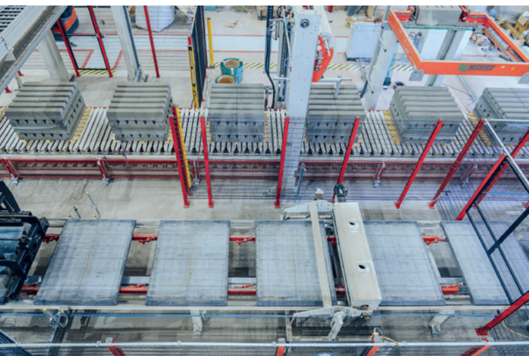
空的生产托板自动移动到码垛机下方并经过清洁站
