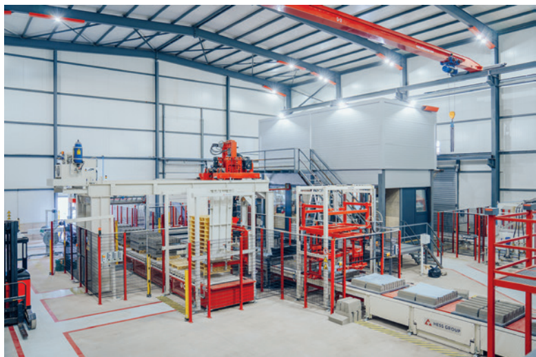
按照设定的节拍，托板在砌块与铺路石分板机下方移动，该设备将产品精确推拢并对齐，以便进行后续工序
