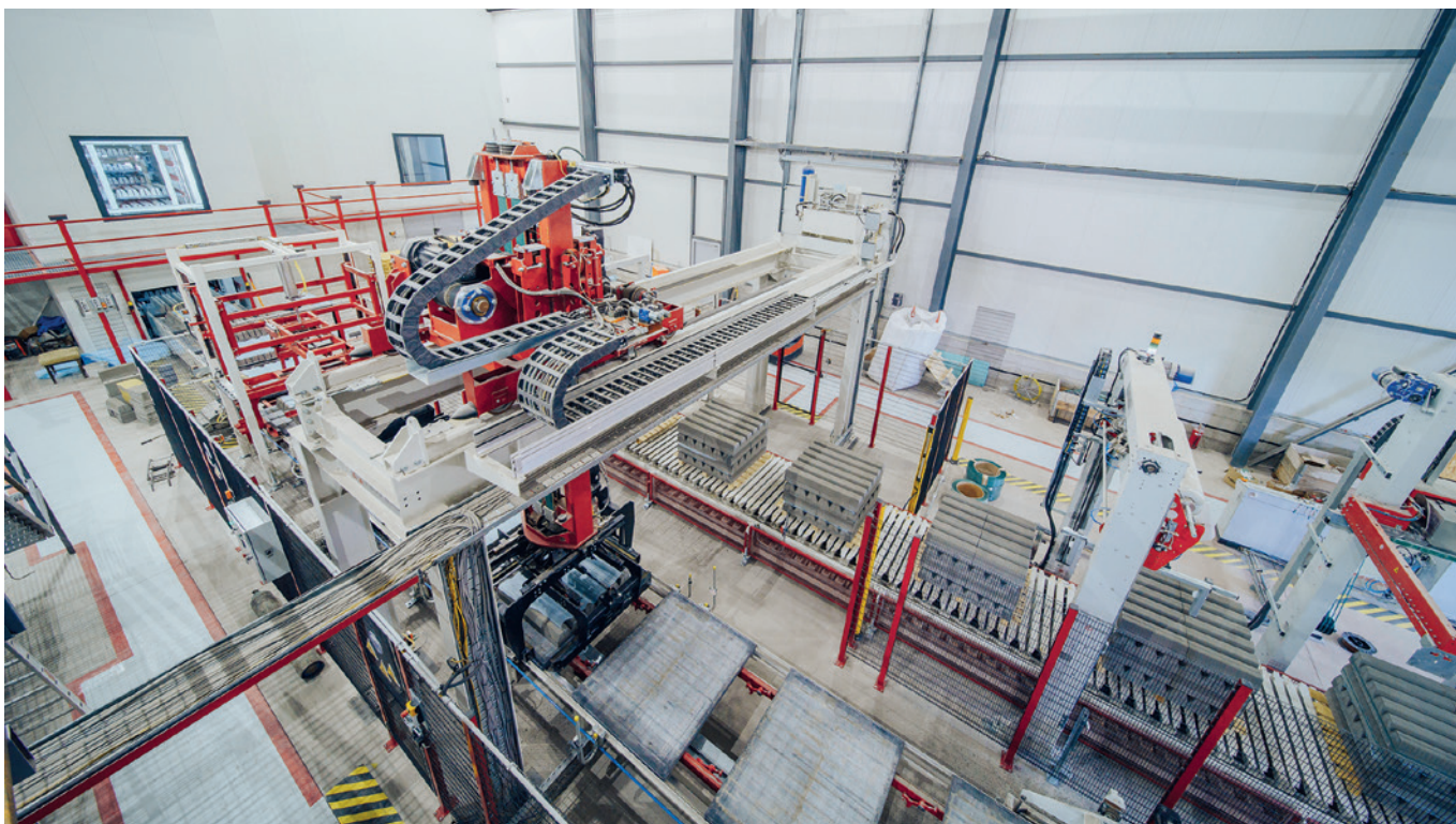
产品移动到码垛机下方，在那里被拾取、对齐，并放置到成品输送带上
