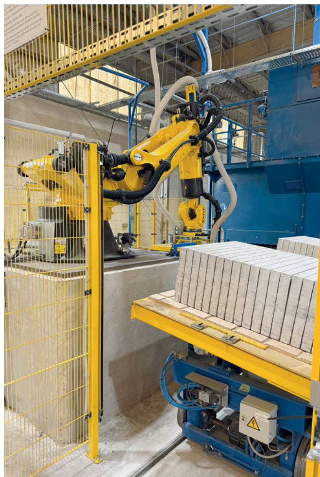
Передаточная тележка с роботизированной системой загрузки
