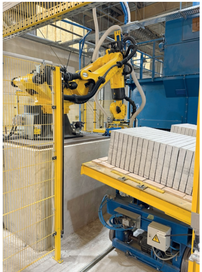
System wózków transportowych z robotem do załadunku i rozładunku.
