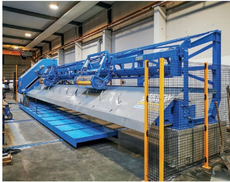
La raddrizzatrice-tagliatrice-piegatrice MSR 20 è progettata per la produzione di barre d'armatura su misura.
