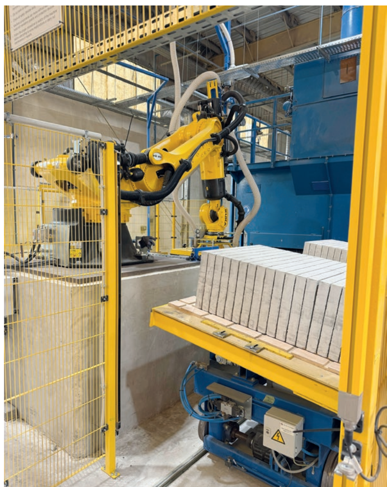
Sistema di navetta con sistema di caricamento con robot
