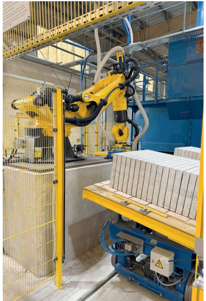
Système de chariots de transfert avec système de chargement robotisé
