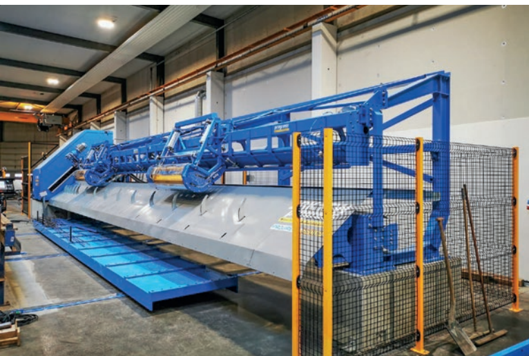
La dresseuse-coupeuse MSR 20 est conçue pour la production de barres d'armature sur mesure.
