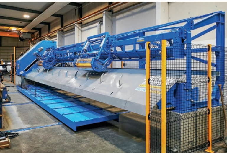
La máquina enderezadora, cortadora y dobladora MSR 20 está preparada para la producción de barras de armadura a medida
