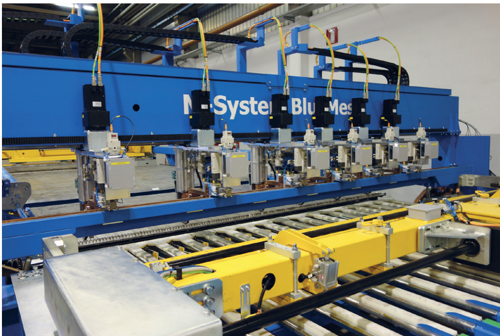
M-System BlueMesh® 钢筋网焊接生产线可根据 individual 规格，直接从盘条生产定制钢筋网片
