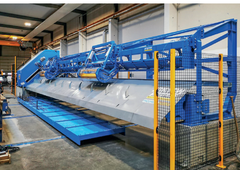
MSR 20 钢筋矫直、切断及弯曲机专为生产定制的钢筋棒材而设计
