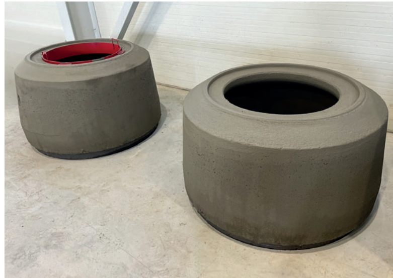
Устье колодца DN 1000/625 BH: 600 мм со смещенным лазом, изготовленное полностью автоматически на установке Tornado 150/150
