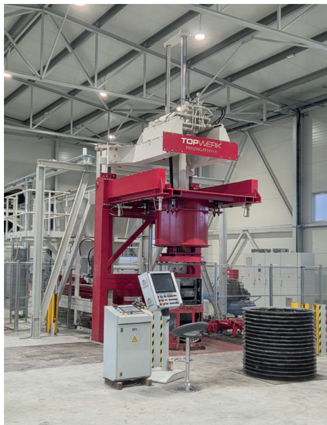
Tornado 150/150: автоматическая заглубленная вибрационная машина для изготовления элементов колодцев и смежных сборных ЖБИ
