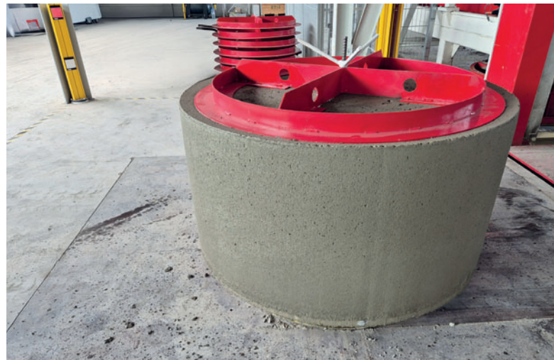
Монолитное кольцо с дном колодца DN 1000 с опорным элементом для твердения, также изготовленным на установке Tornado 150/150
