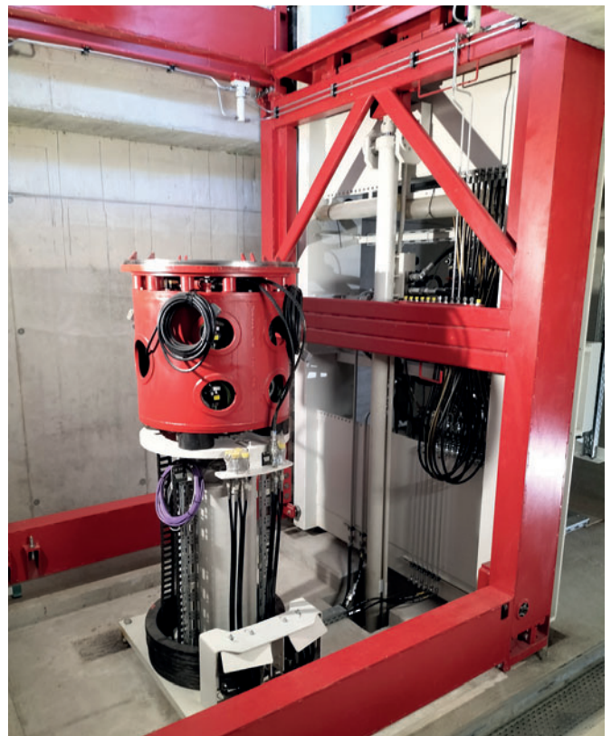
Вертикальный виброуплотнитель VTA 150 с регулировкой амплитуды и подъемным устройством
