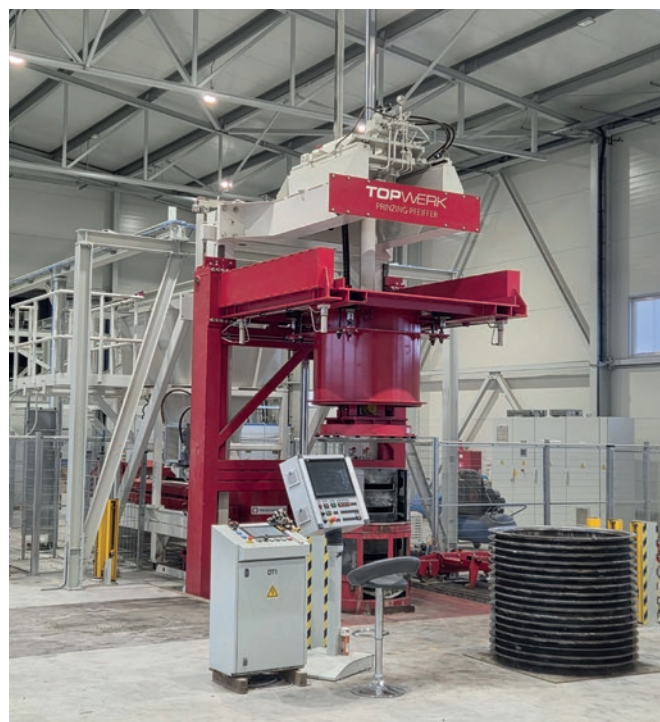
Tornado 150/150: automatyczna podpodłogowa maszyna wibracyjna do produkcji prefabrykowanych elementów studzienek oraz pokrewnych prefabrykatów betonowych.
