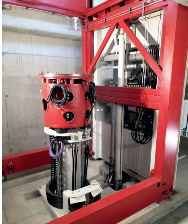
Wibrator pionowy VTA 150 z regulacją amplitudy oraz mechanizmem podnoszenia.
