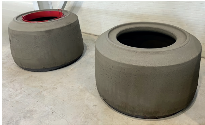
Zwężka DN 1000/625, wysokość konstrukcyjna 600 mm, z przesuniętym wejściem – w pełni automatycznie wyprodukowana przez maszynę Tornado 150/150.
