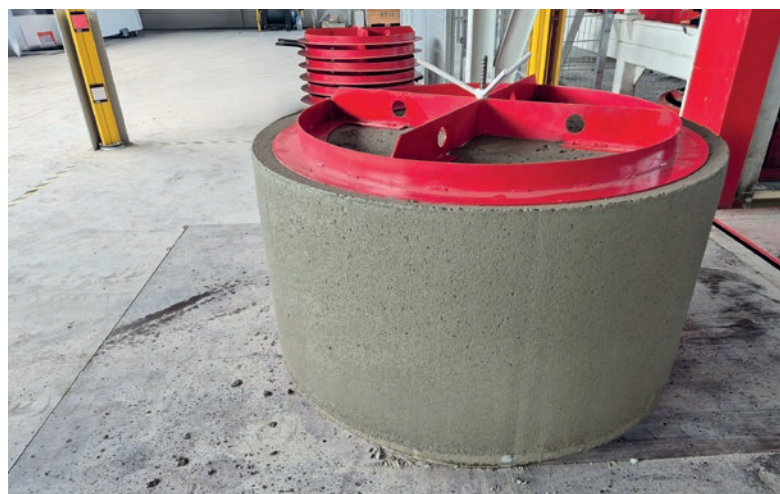
Podstawa studzienki DN 1000 z elementem podporowym podczas dojrzewania – również wyprodukowana przez maszynę Tornado 150/150.
