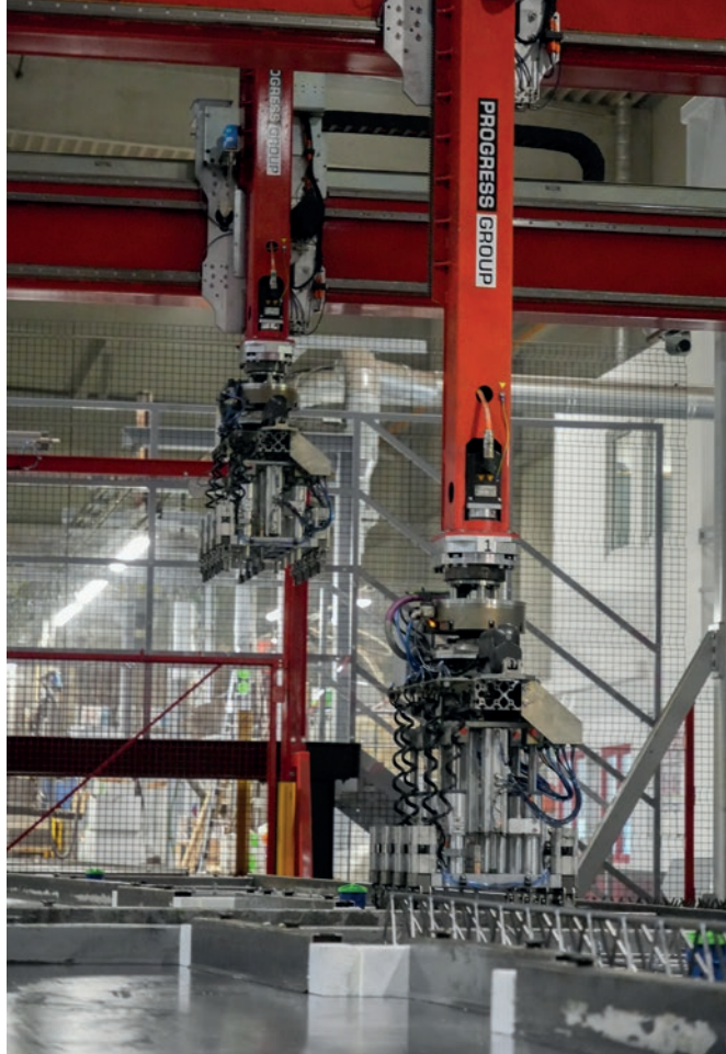
Wire Center umożliwia zautomatyzowane obrabianie i układanie elementów zbrojenia ze stali podawanej z kręgów.
