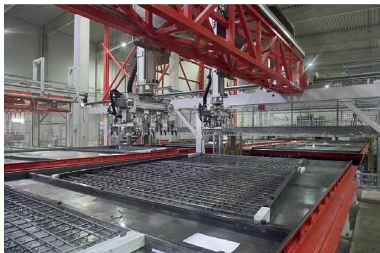
I tralicci e le barre d'armatura vengono posizionate con estrema precisione sui pallet grazie ai dispositivi di presa.
