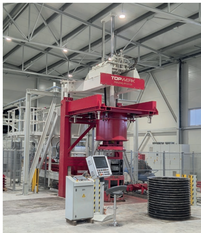
Tornado 150/150: Macchina vibrante automatica sottopavimento per la produzione di elementi per pozzetti e di elementi prefabbricati in calcestruzzo affini
