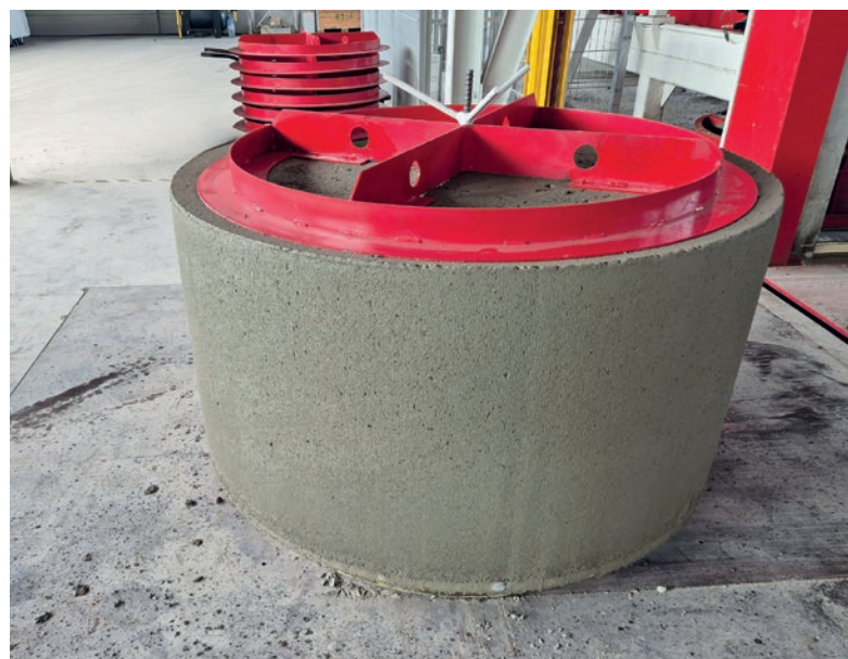
Fondo di pozzetto DN 1000 con elemento di supporto per la maturazione, sempre prodotto sulla Tornado 150/150
