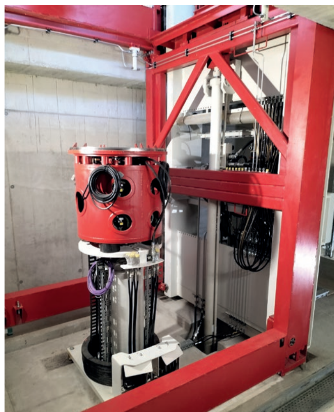
Compattatore verticale VTA 150 con regolazione dell'ampiezza e dispositivo di sollevamento
