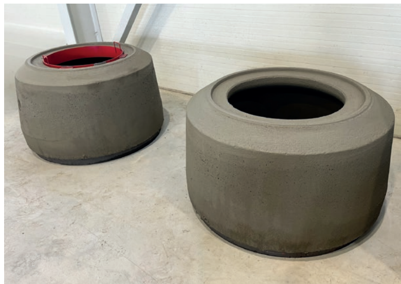
Cono per pozzetti DN 1000/625 BH: 600 mm con ingresso sfalsato, prodotto in modo completamente automatico sulla Tornado 150/150
