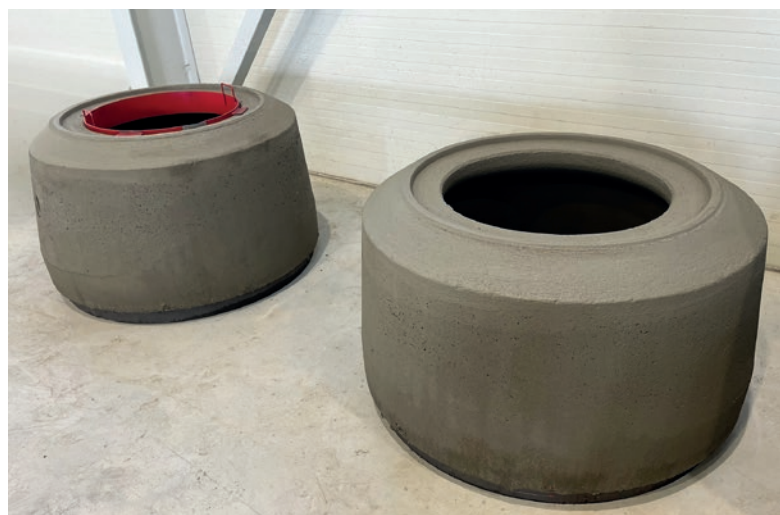
Cône de réduction DN 1000/625 BH : 600 mm avec entrée décalée, fabriqué de manière entièrement automatique sur la Tornado 150/150
