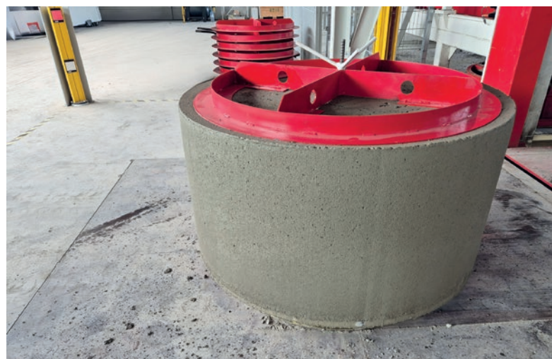
Fond de regard DN 1000 avec élément de support pour le durcissement, également fabriqué sur la Tornado 150/150
