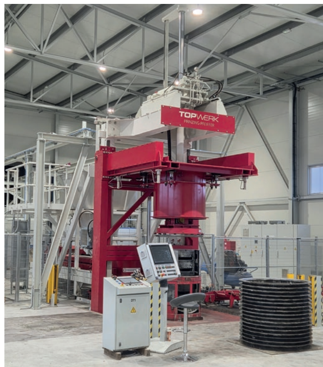
Tornado 150/150 : machine vibratoire automatique souterraine pour la fabrication d'éléments de regards et des éléments préfabriqués en béton afférents
