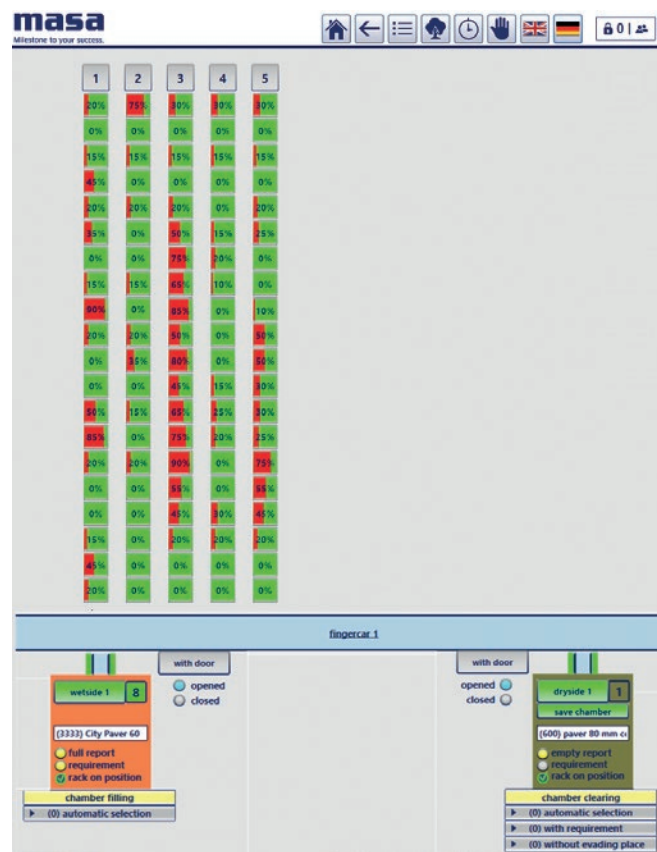
Aperçu de la chambre avec visualisation du pourcentage de rebuts par planche de support
