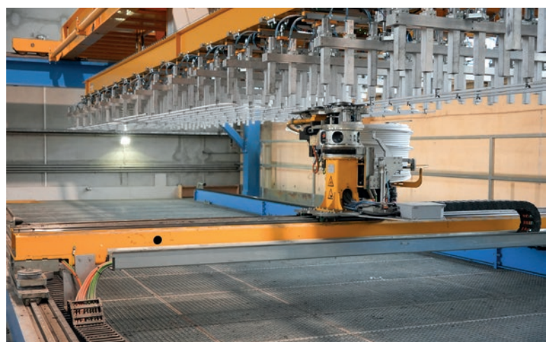
Le robot de pose de tuyaux Tube Master permet la pose automatique de tuyaux de chauffage et de refroidissement dans des éléments préfabriqués en béton.
