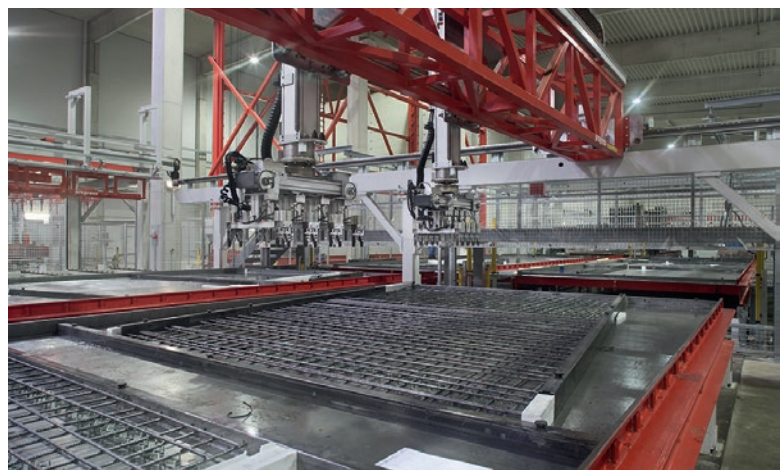
Les raidisseurs et les fers à béton sont placés avec précision sur les palettes à l'aide des pinces.
