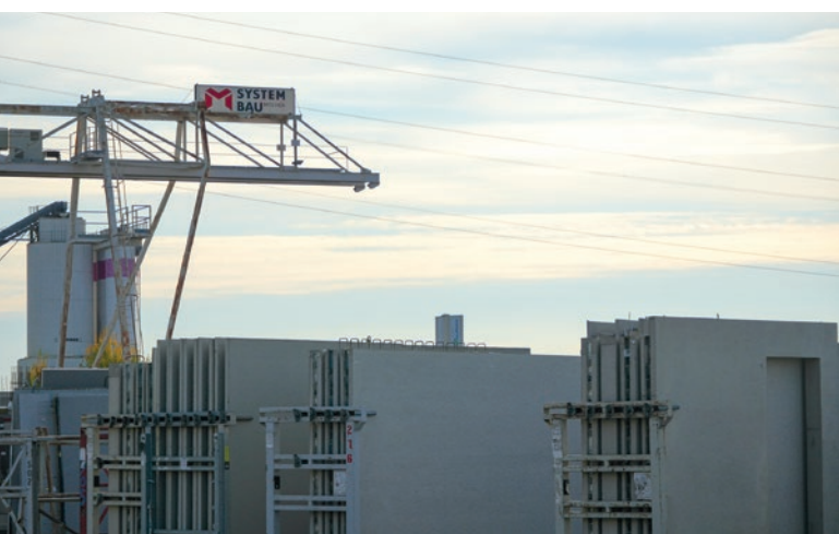
Éléments préfabriqués en béton de Mischek Systembau avant leur transport vers le chantier.
