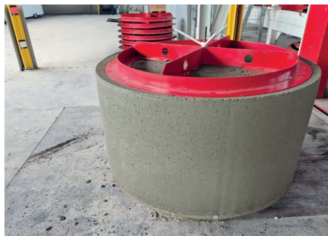
Base de pozo DN 1000 con elemento de apoyo para el curado, también fabricado en la Tornado 150/150
