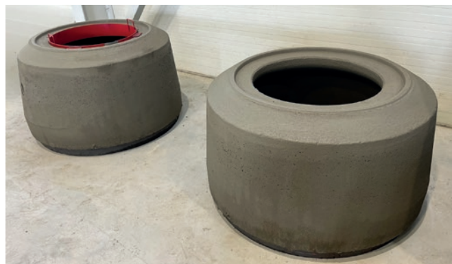
Cono de pozo DN 1000/625, altura constructiva: 600 mm con acceso desplazado, fabricado de forma totalmente automática en la Tornado 150/150
