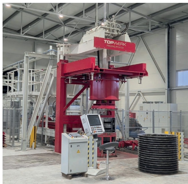
Tornado 150/150: máquina automática de vibración bajo suelo para la producción de elementos de pozo y prefabricados de hormigón relacionados
