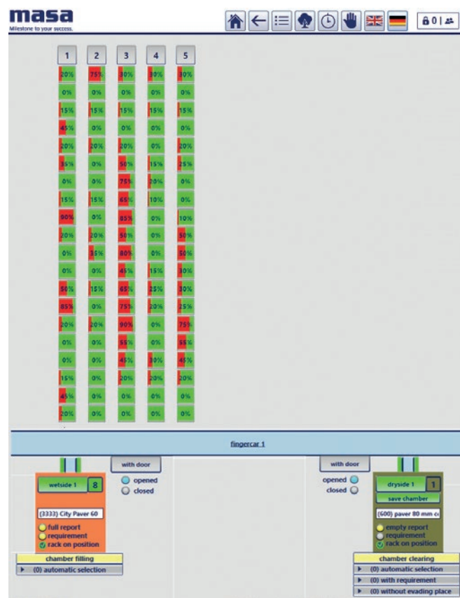
Previsualización de la cámara con visualización del porcentaje de productos rechazados por bandeja de producción
