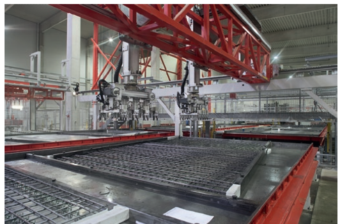
Las armaduras de celosía y las barras de armadura son colocadas con gran precisión sobre las bandejas mediante las pinzas de sujeción.
