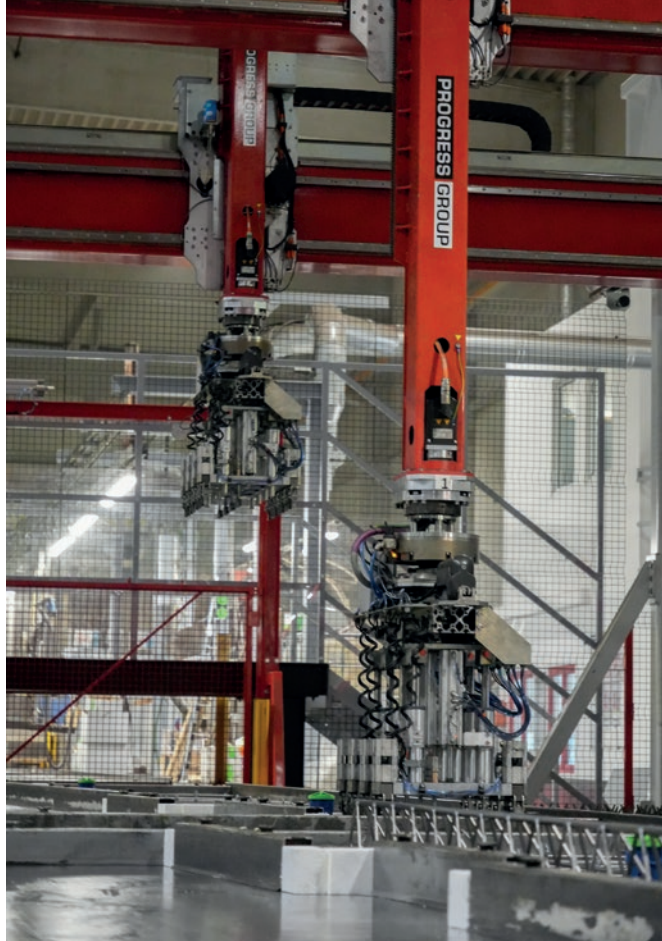
En el Wire Center, el acero de armadura es procesado y colocado de forma totalmente automatizada a partir de bobinas.
