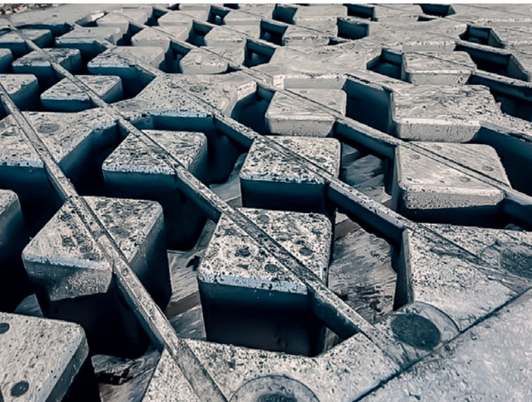
Литые сердечники без сварных швов во вставке формы
