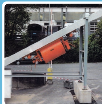
Kubel obrotowy 3.500 l pod kątem 32° = 60%
