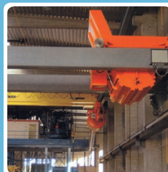
Kubel obrotowy i rozdzielacz betonu 3.000 l
