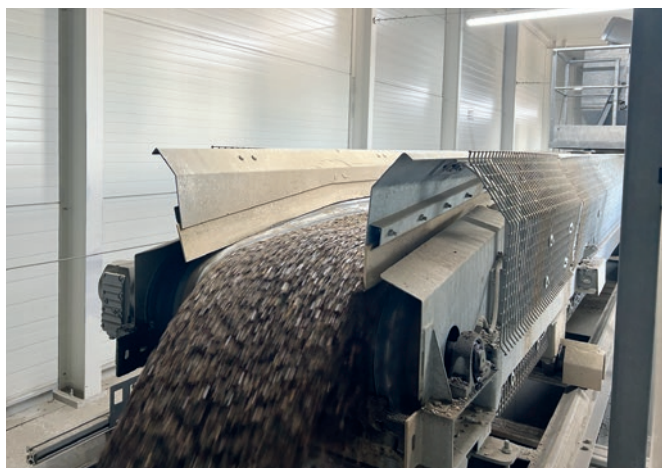
Surowce są automatycznie podawane do odpowiedniej komory po zeskanowaniu kodu kreskowego na dokumencie WZ.
