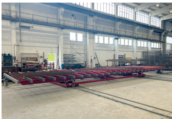
Specjalny wózek do transportu zbrojenia na linię obiegową.
